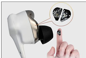
一般的な完全ワイヤレスイヤホンはBluetooth SoCに内蔵したアンプを使うことが多いが、本機は個別にアンプを搭載。しかもAB級のバランス駆動を実現している。
